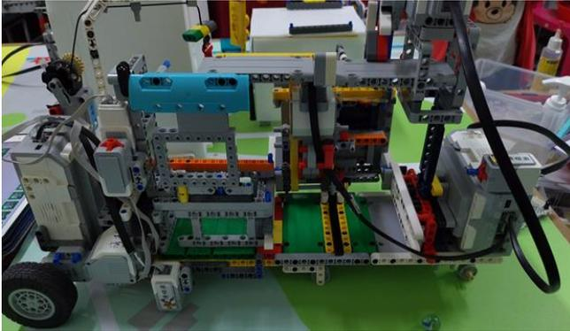
清運車到達後，傳送訊息給翻轉水溝蓋，水溝蓋打開，落葉掉進水溝裡，卡匣把落葉收集起來，之後清運車就會替換一個新的卡匣。
